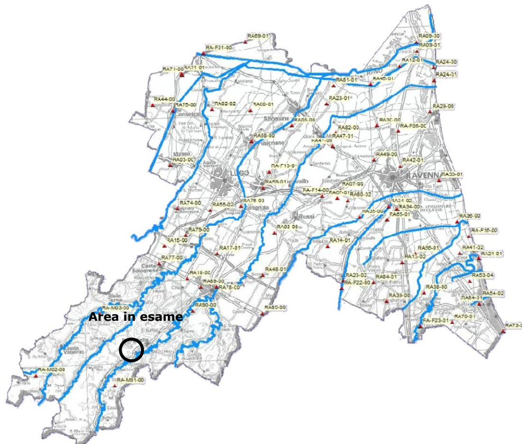
Figura B-28: Distribuzione territoriale delle stazioni di misura della rete di monitoraggio ambientale acque sotterranee
